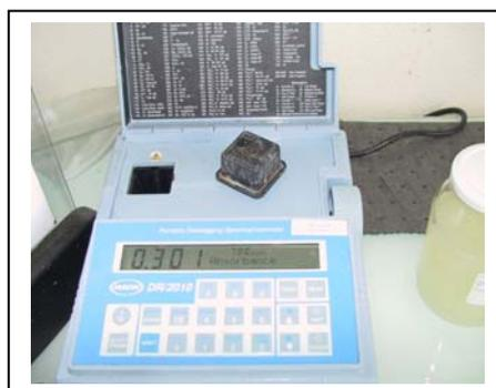
Figure II.47 : Spectrophotomètre mètre UV - Visible
