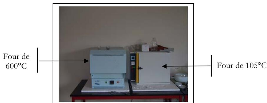
**Figure II.46:** Four à 600°C (détermination de la MV) et à 105°C (détermination de la MS)
