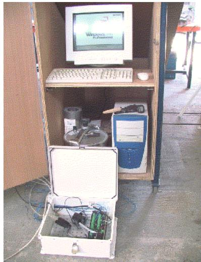
**Figure.II.3** : La chaîne d'acquisition
