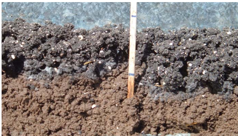
Figure II.23: Stratification de la couche de boue au cours du séchage sans opération de retournement
