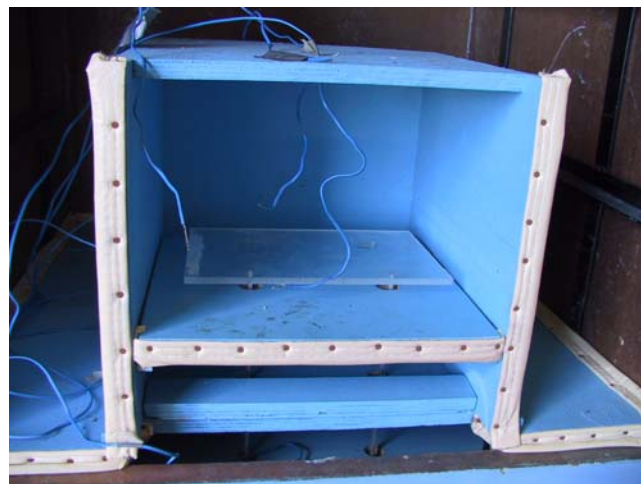
Figure. II.5: Configuration associée à la mesure et à l'établissement des modèles des paramètres de cinétique de séchage du produit étudié
