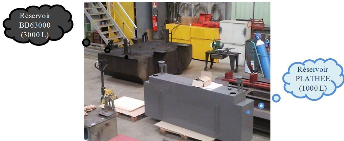
Figure 1.23. Réservoirs de gasoil des deux locomotives BB63000 et PLATHEE
