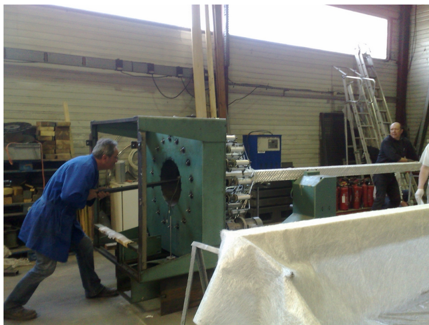
FIG. A.5 – Guidage de la poutre au travers de l'unité de tressage
