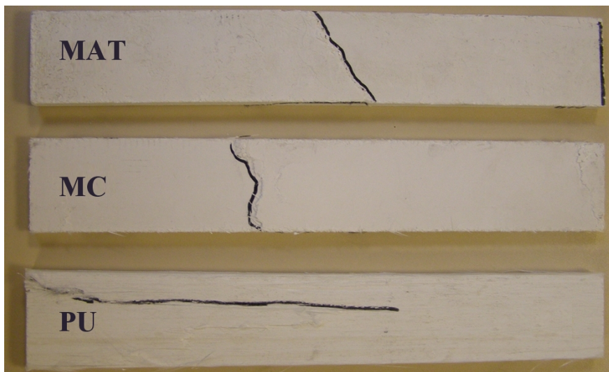
FIG. 4.14 – Faciès de rupture en compression
