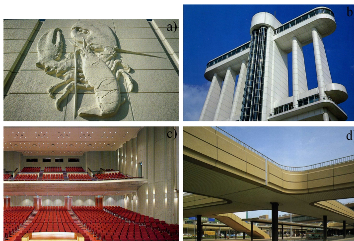
FIG. 1.13 – Quelques applications de système composites GRC : a) et b) Avantages du GRC pour la réalisation d'éléments de formes complexes, c) Hall de lecture de l'université de Tokyo - utilisation des propriétés acoustiques, d) Passerelle piétonne combinant faible poids et résistance aux vibrations
