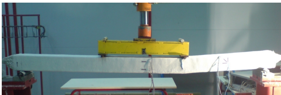
FIG. B.4 – Déformée de la poutre PU/C.TV-CM/2.05
