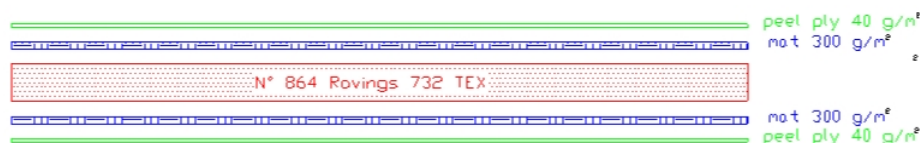
FIG. 3.19 – Profil transversal des plats pultrudés puis compressés
