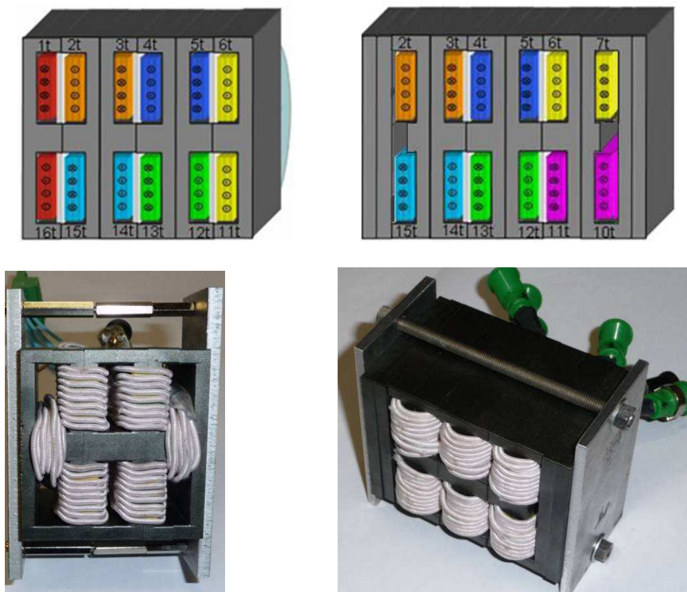
Figure 2-66: Topologies circulaires à noyau standard modifié. A gauche : topologie présentée dans [Costan 2007] ; A droite : topologie modifiée
