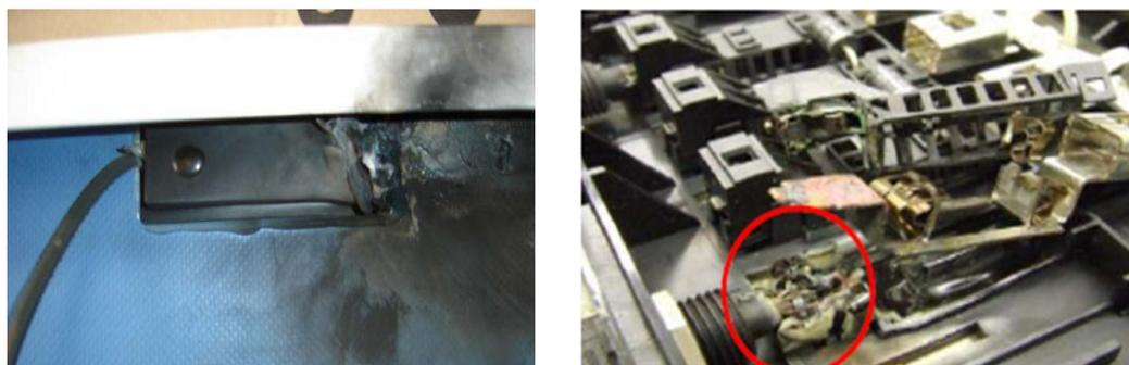
Figure A-2 : Exemples de défauts rencontrés dans des boîtes de jonction
