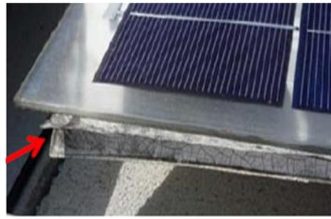
(h) défaut mécanique de la face arrière
