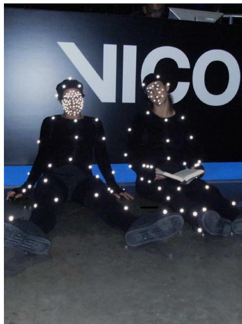
FIGURE 1.19 – Cibles rétro-réfléchissantes [vic09]
