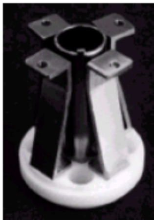
Figure 1.20 : Echantillons utilisés pour l'expérience réalisée dans le réacteur de recherche du MIT. La gaine en zircaloy (le tube) et les contre-électrodes sont séparés par de l'alumine, d'après [66]. La distance minimale entre la gaine et les contre-électrodes est de 0.5 mm.
