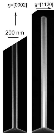
FIGURE 3.47: Images MET de nanofils de ZnO
