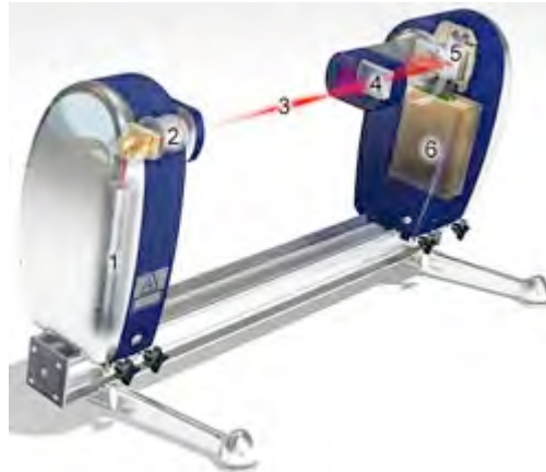
Figure B.15. Schéma d'un granulomètre Laser utilisant la technique Spraytec®
