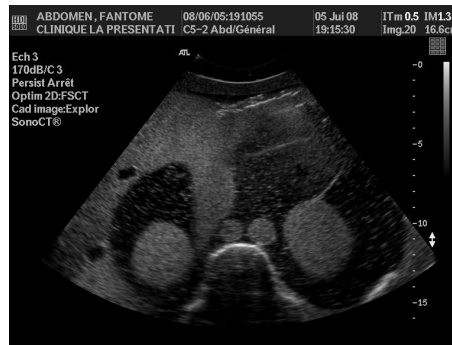
Figure I.10 – Image de fantôme abdominal en mode B
