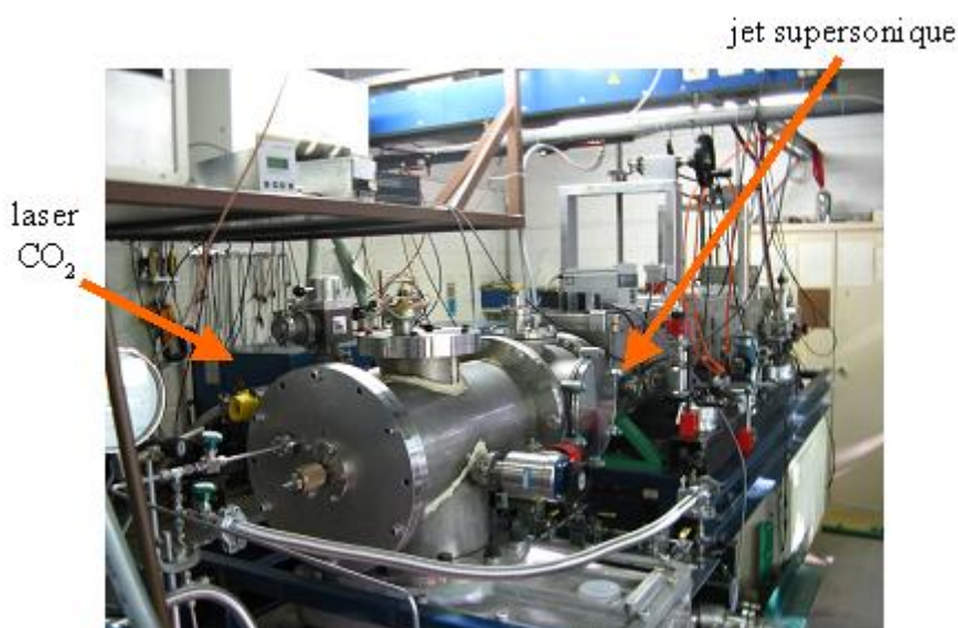
Photo 1 : Vue d'ensemble du spectromètre avec le jet supersonique et le laser CO 2 .
