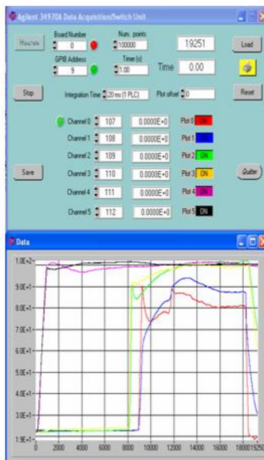
Figure I.5 Interface du programme d'acquisition où sont représentés l'évolution de la température des différents thermocouples en fonction du temps pour une expérience typique de chauffage.
