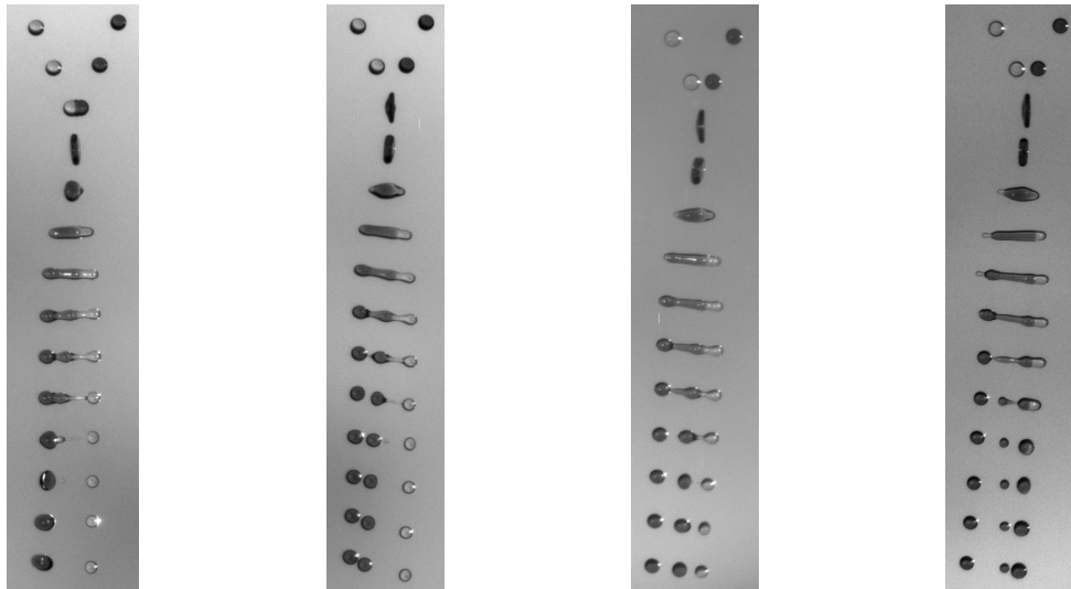
FIGURE 2.15 – Collision entre une goutte de SO M5 et une goutte de G50. A gauche, U = 4.84m/s et on voit une séparation croisée. Les deux photographies centrales montrent des séparations à la fois croisée et mixte pour des vitesses valant 5.05m/s et 5.25m/s . À droite, une séparation mixte, U = 5.77m/s .
