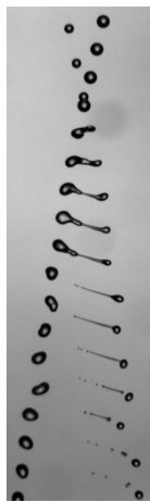
FIGURE 2.61 – Collision entre une goutte de G50 de 115\mu\text{m} et une goutte de SO M3 de 158\mu\text{m} de diamètre. U=5.6\text{m/s} et X=0.59 . Il est difficile de mesurer l'efficacité d'encapsulation à partir de cette photographie car la goutte enrobée oscille et que les gouttelettes d'huiles sont petites.
