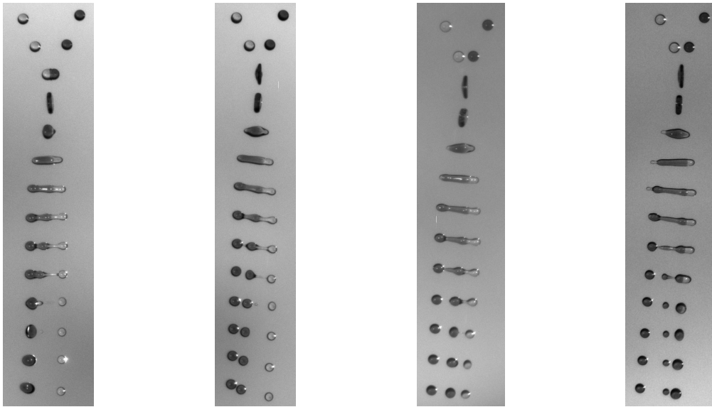
FIGURE 2.35 – Collision frontale entre une goutte de SO M5 et une goutte de G50. L'intervalle de temps entre deux paires de gouttes successives est de 100\mu\text{s} . À gauche, U = 4.84\text{m/s} et on voit une séparation croisée. Les deux photographies centrales montrent des séparations à la fois croisée et mixte pour des vitesses valant 5.05\text{m/s} et 5.25\text{m/s} . À droite, une séparation mixte, U = 5.77\text{m/s} .
