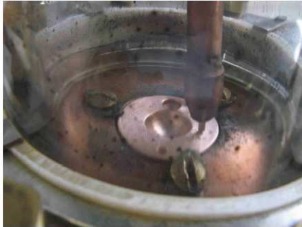
Figure 2.2 Enceinte du four à arc utilisé, avec l'électrode et le creuset
