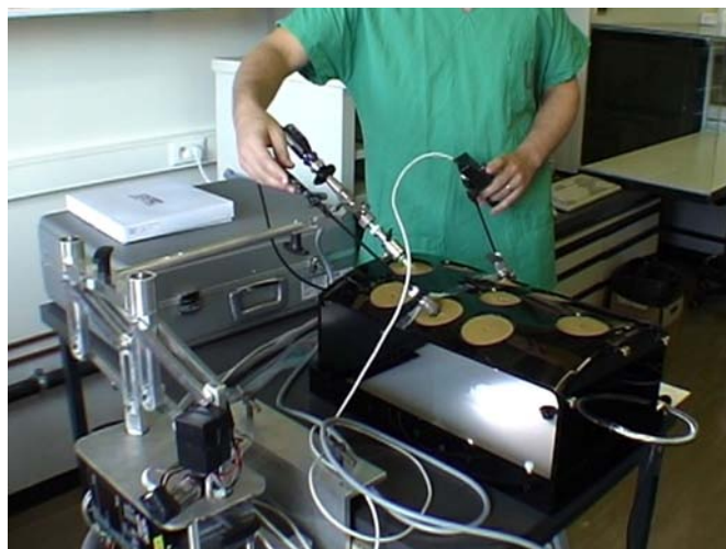
FIGURE 10.2 – Essai de mise au point de la commande de l'EVOLAP sur pelvitrainer
