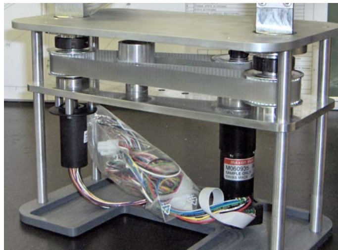
FIGURE 5.32 – Détail de la base du manipulateur, renfermant la transmission par courroie crantée et le contact tournant
