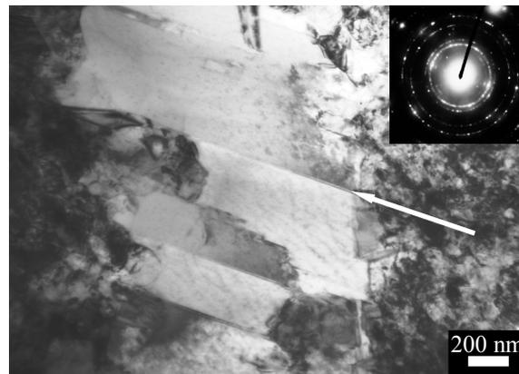
Figure 3.23 : Images MET en champ clair du nanocomposite Cu-Fe en vue de dessus déformé à la température de l'azote liquide ( $T=77$  K) par 5 tours de HPT, associée à son cliché de diffraction électronique. La flèche indique la présence de maclage pour les gros canaux de cuivre.
