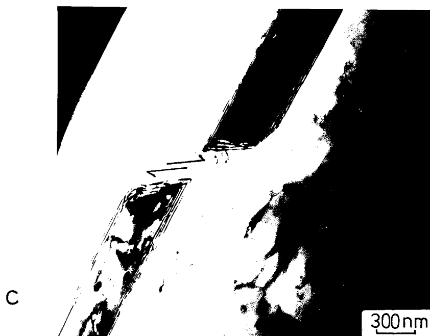
Planche V.3 : Caractérisation de macles mécaniques (110) . a) aragonite chauffée. b) polycristal déformé. c) macle cisillée (polycristal déformé).
