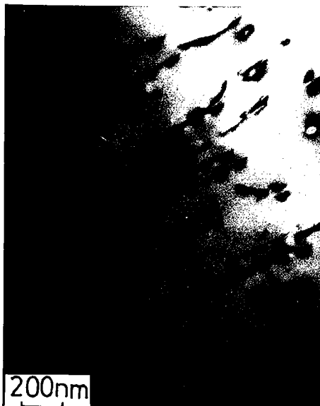
Planche V.2 : a) dislocations de vecteur de Burgers [100] dont la ligne est suivant la direction [101] (Monocristal d'aragonite). b) dislocations de vecteur de Burgers [001] glissant dans le plan (110) (Aragonite déformée).
