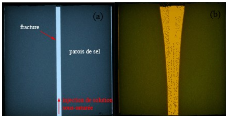
Figure 14. Dissolution expérimentale d'une fracture verticale pour un débit d'injection Q=15 \text{ mL.h}^{-1} : (a) état initial et (b) après dissolution.
