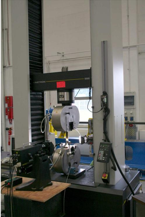
(a) Machine de traction-compression conventionnelle
