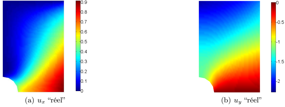
FIGURE 2.5 – Déplacements calculés par le code EF en fin de chargement de traction-compression
