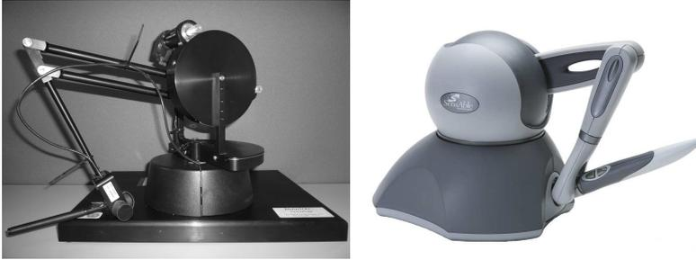
**Figure 20.** Exemples de bras robots à retour de force utilisés dans cette thèse : le PHANTOM Desktop 1.5 (à gauche) et le PHANTOM Omni (à droite).
