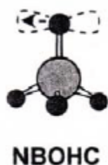
Figure 16 : Représentation schématique du défaut NBOHC [22].
