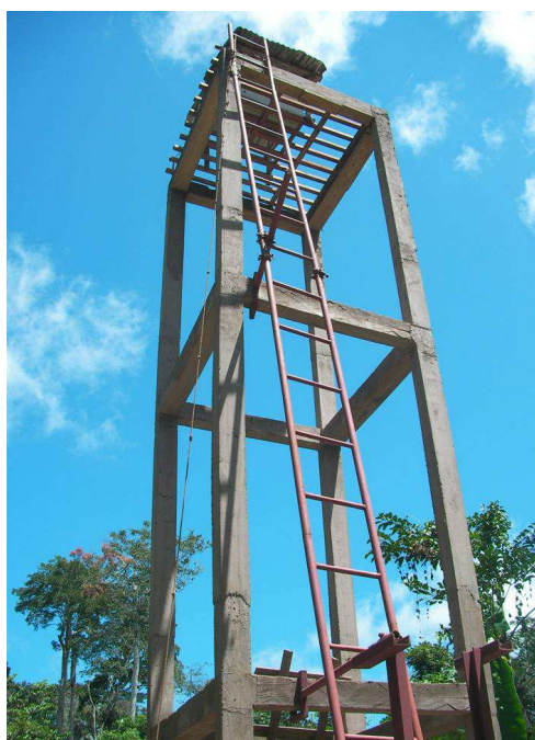
Photo1 : Mât de mesure des concentrations des gaz à 10 m à Zoétélé (forêt).
