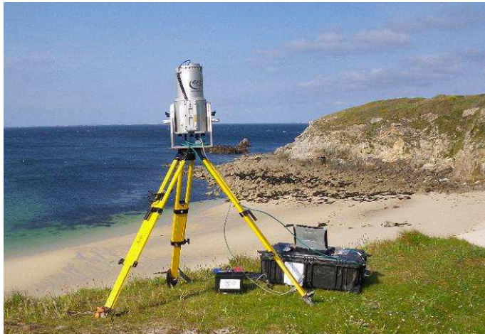
Figure II.29 : Scanner laser terrestre RIEGL LMS-Z390i utilisé par le laboratoire Domaines Océaniques.
