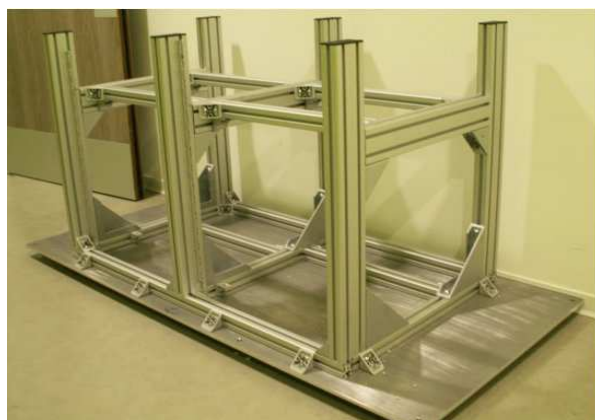
FIGURE 2.4 – Gauche : structure en profilés ELCOM montée sur une plaque d'embase en duraluminium avant agencement des différents appareils. Ce type de structure offre une grande modularité pour l'installation des instruments de l'expérience, et permet de satisfaire les critères de sécurité mécanique exigés par la DGA-EV. Droite : photographie du bâti n°4 après y avoir agencé divers instruments.
