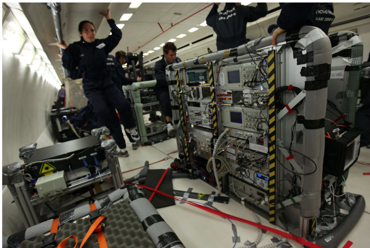
FIGURE 2.16 – Photographie de l'expérience durant une phase d'apesanteur, lors de la campagne de vol d'octobre 2009. Au premier plan à gauche on aperçoit la chambre de science dans son blindage magnétique entouré de mousses protectrices et enlacé de sangles oranges (bâti n° 1). Au second plan à gauche on remarque le banc laser en espace libre (rack noir) sur la partie supérieure du bâti n° 3. Sur la droite, le bâti n° 2 (le plus imposant) regroupant les sources laser à 1560 nm, la référence de fréquence à 6.8 GHz ainsi que les principaux appareils de contrôle de l'expérience.
