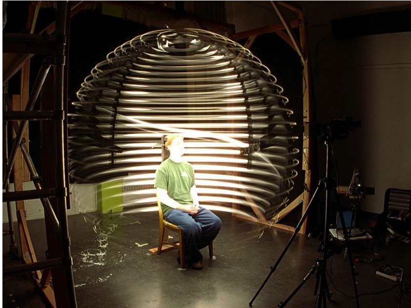
Figure 21 - Première version du système LightStage , la structure de caméra et de lumière est ici en rotation (effet de traînées lumineuse) (Debevec et al., 2000)
