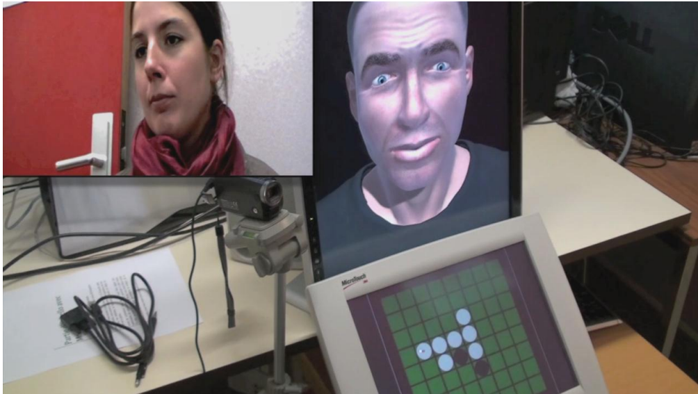
Figure 78 - Une utilisatrice jouant au reversi contre notre agent virtuel. (L'écran inférieur est tactile). Le cadre en haut à gauche montre l'image de l'utilisatrice filmée par la caméra située à gauche de l'agent virtuel.
