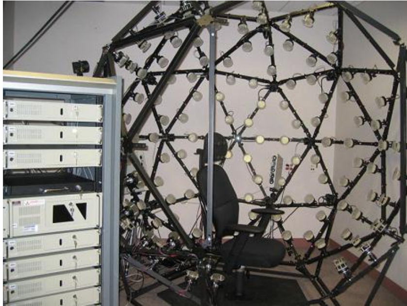
Figure 23 - Dispositif de capture de réflectance de Weyrich et al. (2006)
