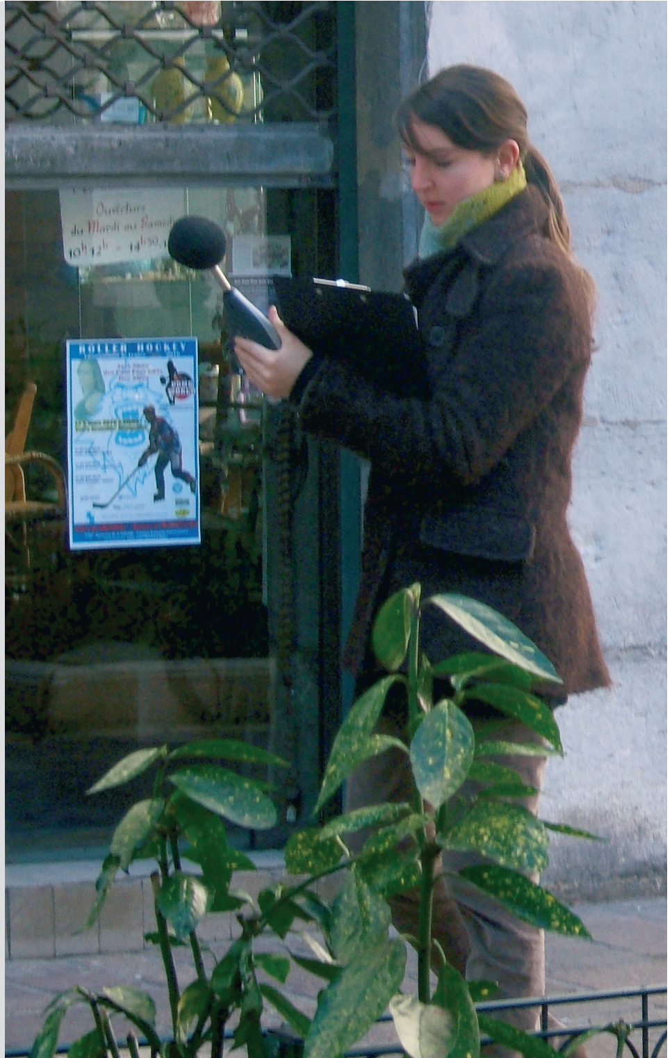
Mesure acoustique in situ , sonomètre (modèle SLS95S, 01dB), enregistrement des LA_{eq\ 1s} Place des Tilleuls
