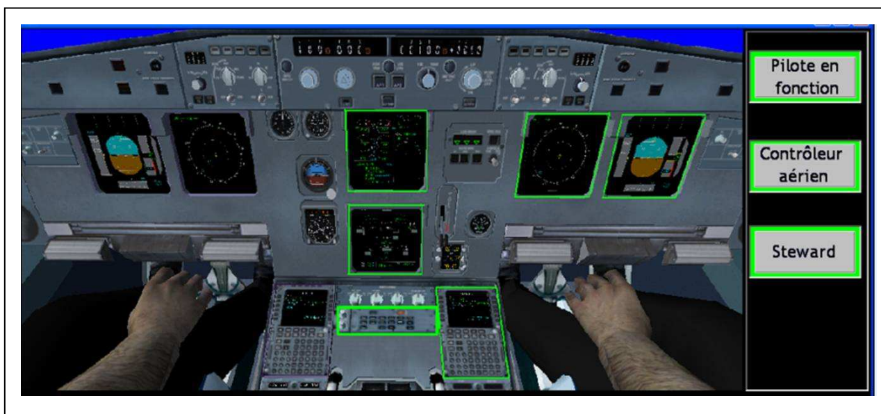
Figure 17. Interface de la simulation de vol représentant le tableau de bord de l'A319. La zone de droite représente les sources de messages verbaux provenant d'acteurs du vol. Les zones encadrées en vert sont celles accessibles aux participants.
