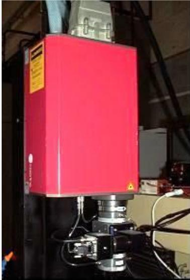
Figure A1-4. Laser *LDL 160-1500* de *LASERLINE*
