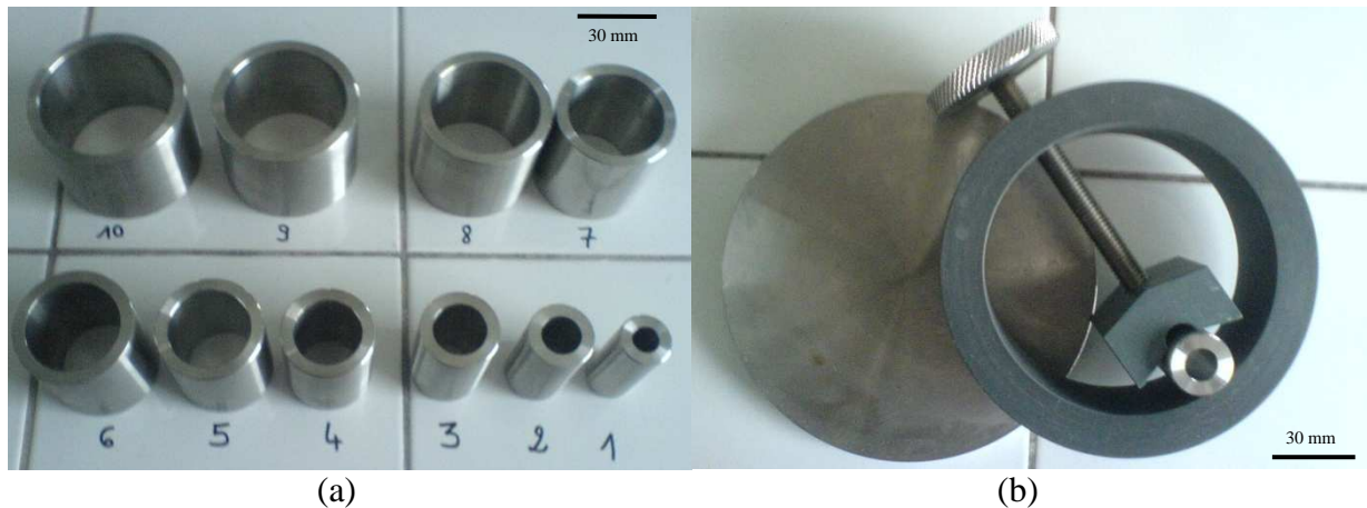
Figure II-6 : Tubes (a) utilisés pour la méthode du Consistor Baronnie introduits dans le système d'ouverture (b) pour évaluer la consistance d'un mortier.
