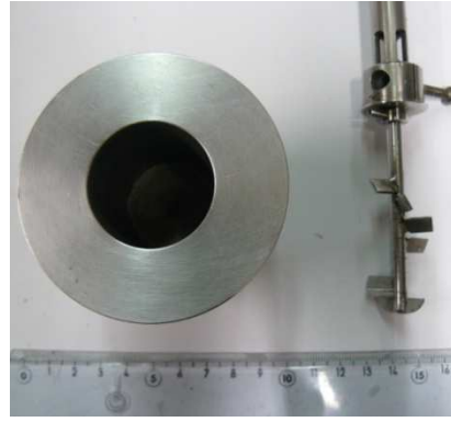
Figure II-10 : Géométrie en colimaçon.
