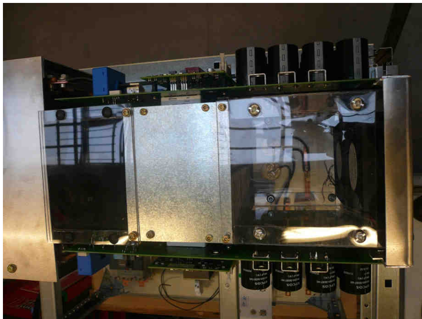
Figure IV-5 : Radiateur, modules et circuit imprimé montés
