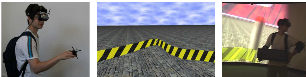
Figure B.9 – Le Bandeau Magique en utilisation: l'utilisateur (gauche) pousse le Bandeau Magique (milieu) pour se déplacer dans l'EV. N'importe quelle partie du corps avec suivi peut être utilisée, comme par exemple le coude (droite).
