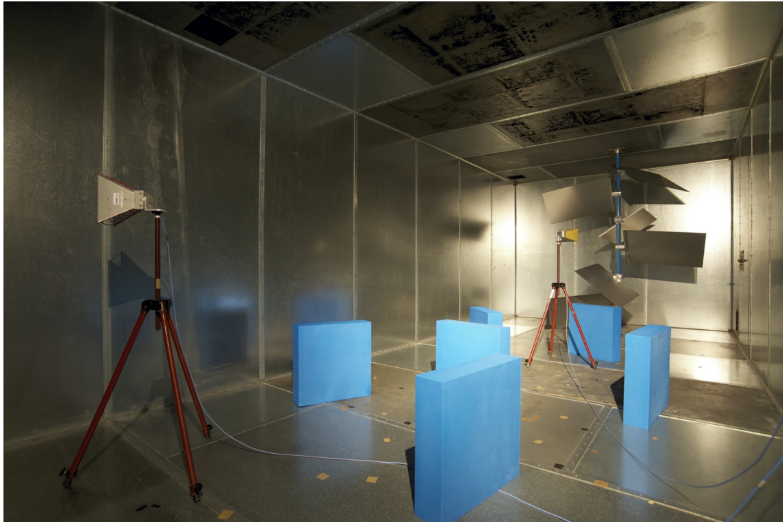
FIGURE 9.5 – Configuration de la chambre avec n = 6 blocs absorbants debout.
