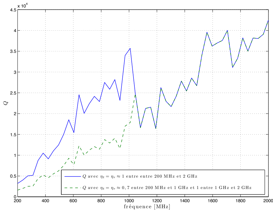
FIGURE 10.1 – Facteur de qualité mesuré en considérant les efficacités identiques et proches de 1 pour le couple d'antennes log-périodiques (200 MHz – 1 GHz) et pour les antennes cornets (1 GHz – 2 GHz), et facteur de qualité corrigé en considérant une efficacité proche de 0,7 pour les antennes log-périodiques [109].
