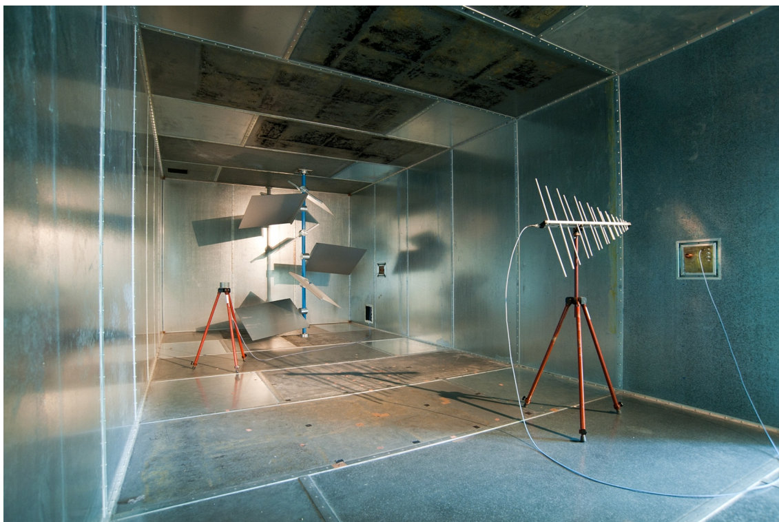
FIGURE 1.1 – Photographie de la chambre réverbérante de l'IETR. On peut notamment distinguer le brasseur mécanique en arrière plan et un couple d'antennes constitué d'une antenne discone et d'une antenne log-périodique.
