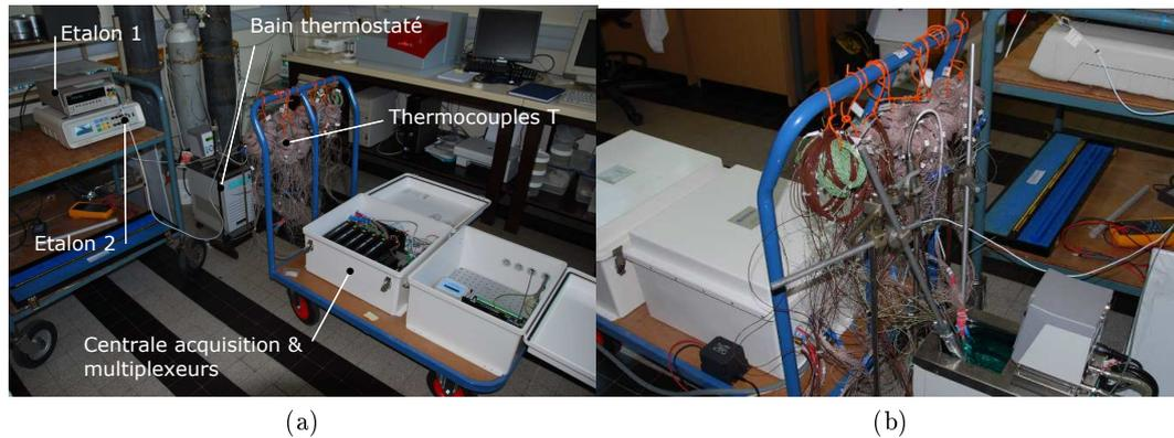
FIGURE 3.2 – Dispositif d'étalonnage en température (thermocouples et fluxmètres).
