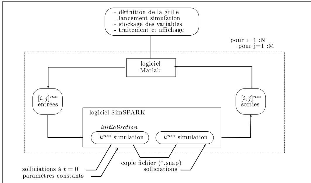
FIGURE 2.1 – Présentation du principe de couplage des outils pour l'analyse paramétrique à deux variables.
