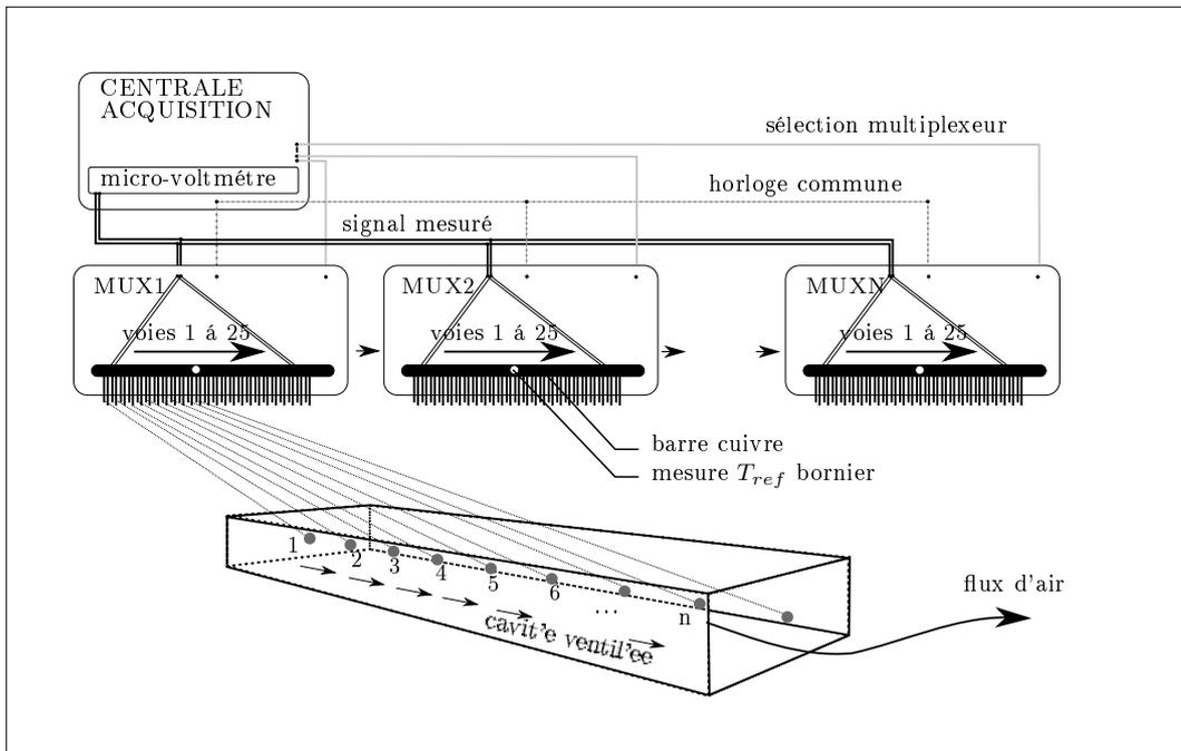
FIGURE 3.8 – Schéma de principe du système d'acquisition
