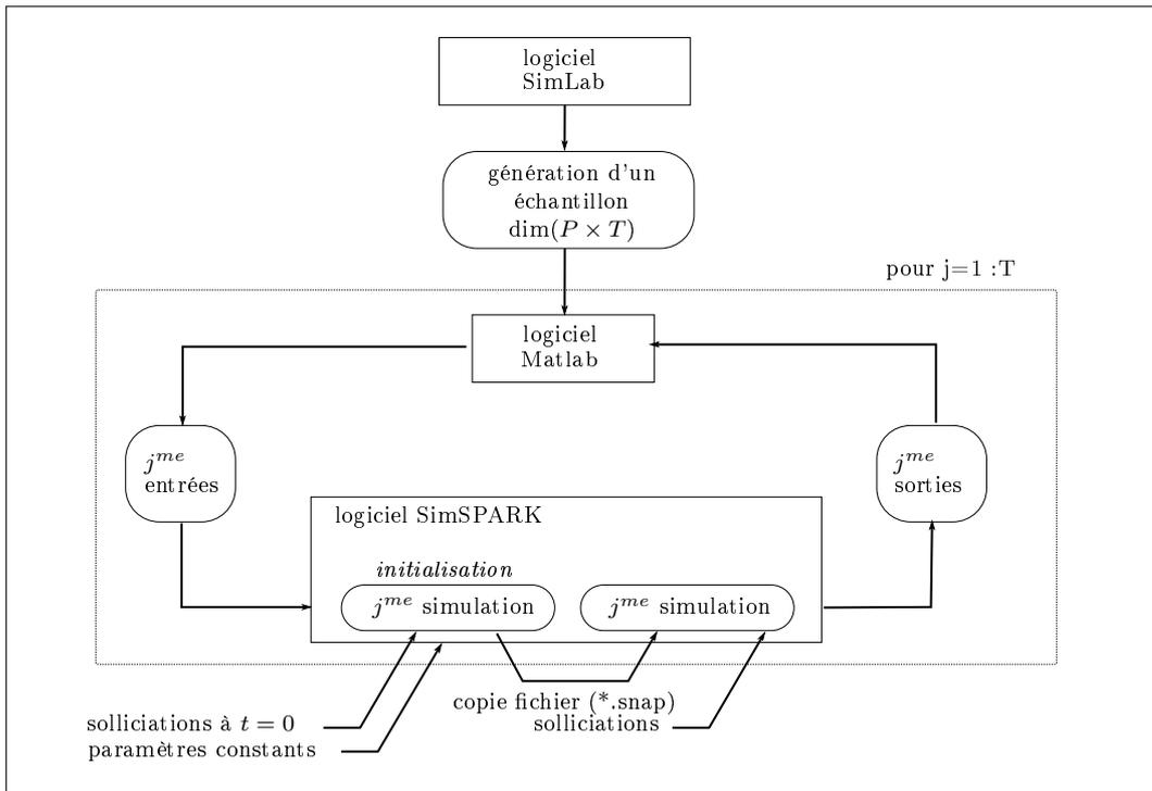
FIGURE 2.2 – Présentation du principe de couplage des outils pour la propagation d'incertitude.
