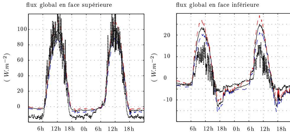
FIGURE 4.2 – Somme des composantes radiatives et convectives calculées et simulées au niveau des interfaces supérieures et inférieures de la cavité inclinée ventilée.
