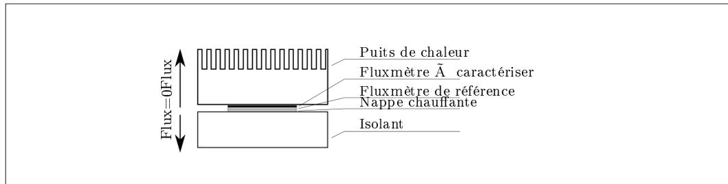
FIGURE 3.5 – *Caractérisation des fluxmètres, montage 2.*
