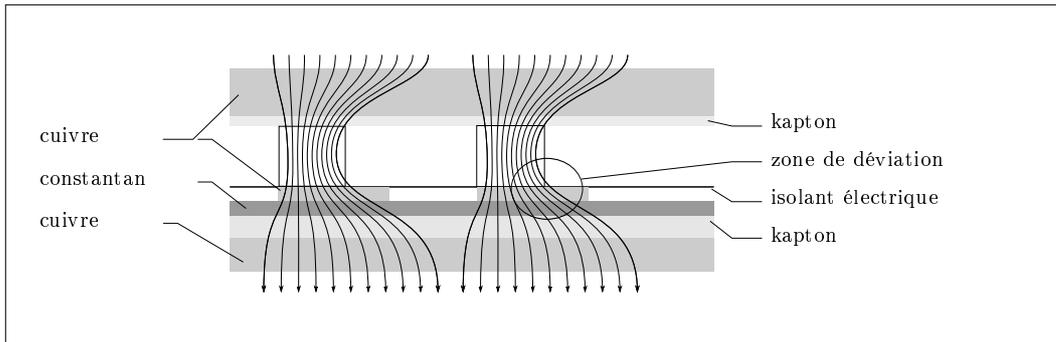
FIGURE 3.3 – Représentation schématique du capteurs fluxmétriques tangentiels Captec.
