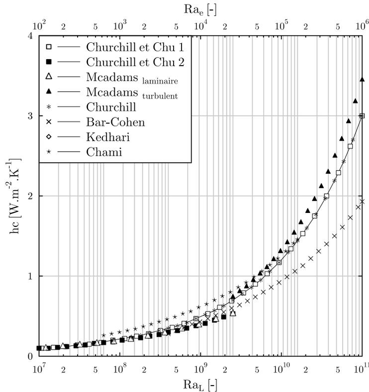
FIGURE 2.13 – Coefficients d'échange convectif en fonction du nombre de RAYLEIGH ( $Ra_L, Ra_e$ ) pour la géométrie suivante ( $L = 4500, e = 95, \theta = 30^\circ$ ) et un  $\Delta T$  allant de 0.1 à 60 °C.
