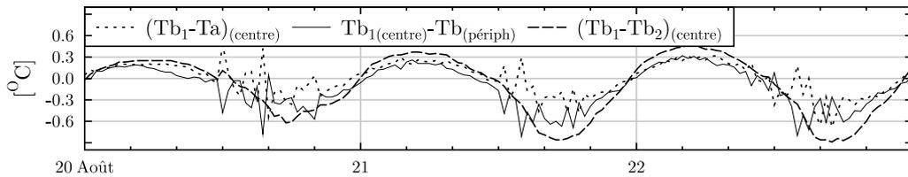
FIGURE 3.37 – Différence de températures au sein d'un nodule disposé en partie centrale, entre un nodule et l'air en partie centrale et entre deux nodules positionnés au centre et en périphérie de la section, pour la section numéro 5.
