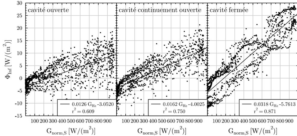
FIGURE 3.21 – Flux transmis en fonction du flux solaire incident normal à la toiture.
