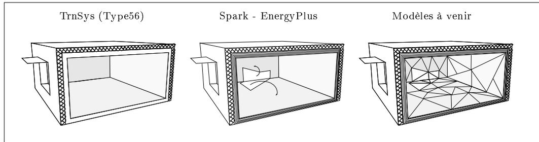
FIGURE 2.4 – Présentation de différents niveaux de finesse liés à la prise en compte de l'inertie dans les outils de simulation.
