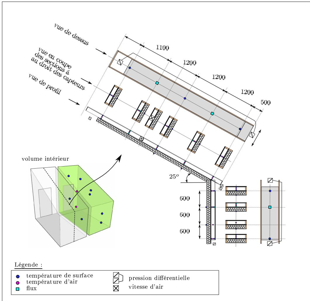
FIGURE 3.14 – Plan d'instrumentation du demi-volume Est
