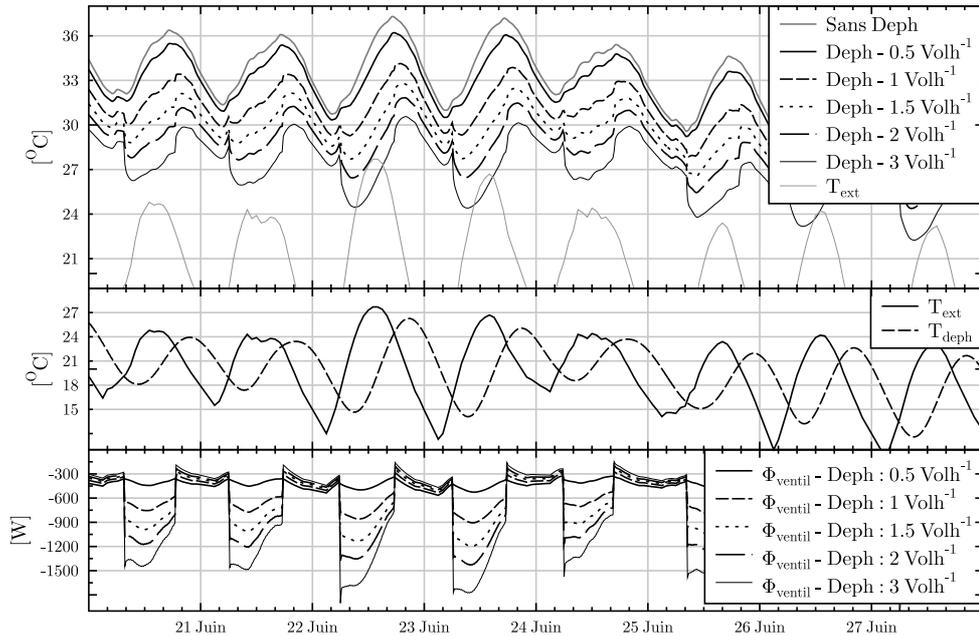
FIGURE 4.12 – Température à l'étage du bâtiment bois lorsque son entrée d'air a la possibilité d'être connectée à la sortie du système de déphasage thermique.
