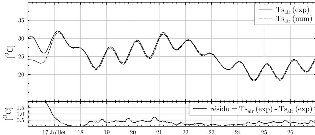
FIGURE 4.5 – *Fonctionnement permanent, résultats après calibration du modèle pour la période du 16 Juillet au 27 Juillet 2010 ( $hc = 11.8 \text{ W.m}^{-2}.\text{K}^{-1}$  et  $Li = 18.5 \text{ cm}$ ).*
