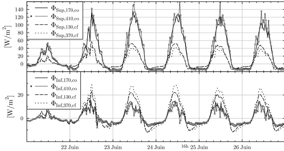
FIGURE 3.18 – Flux surfaciques mesurés pour la (CO) et la (CF) pour la période du 21 au 27 Juin.
