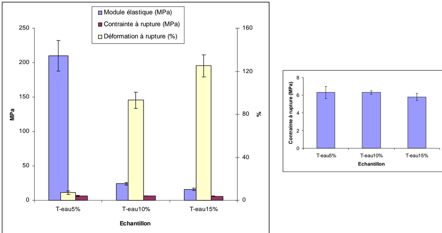
Figure 3.5 : Propriétés mécaniques des mélanges amidon/PVA en fonction de la teneur en eau.
