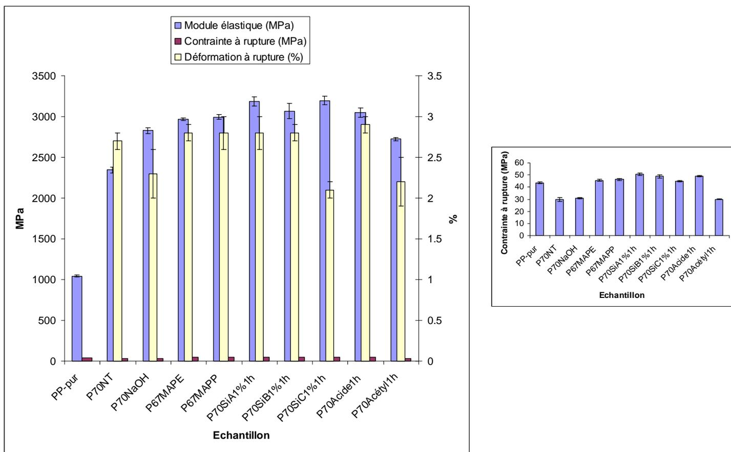
Figure 2.23 : Propriétés mécaniques des composites renforcés par des fibres avec compatibilisants ou agents de couplage (déformation à rupture du PP pur = 996%).
