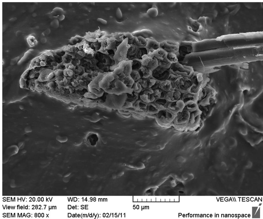
Figure 3.23 : Image MEB d'un composite amidon/PVA/fibre (TFB10).
