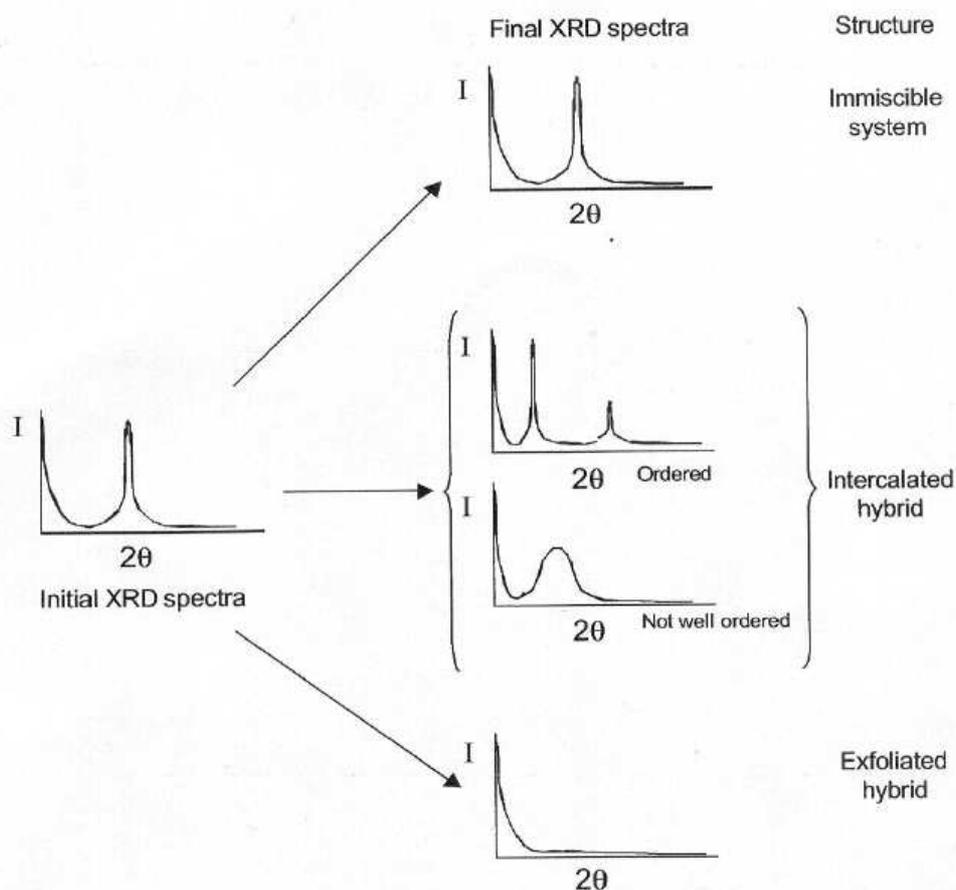
Figure 2.10 : Diffractogramme des différentes structures nanocomposites. <sup>[88]</sup>
