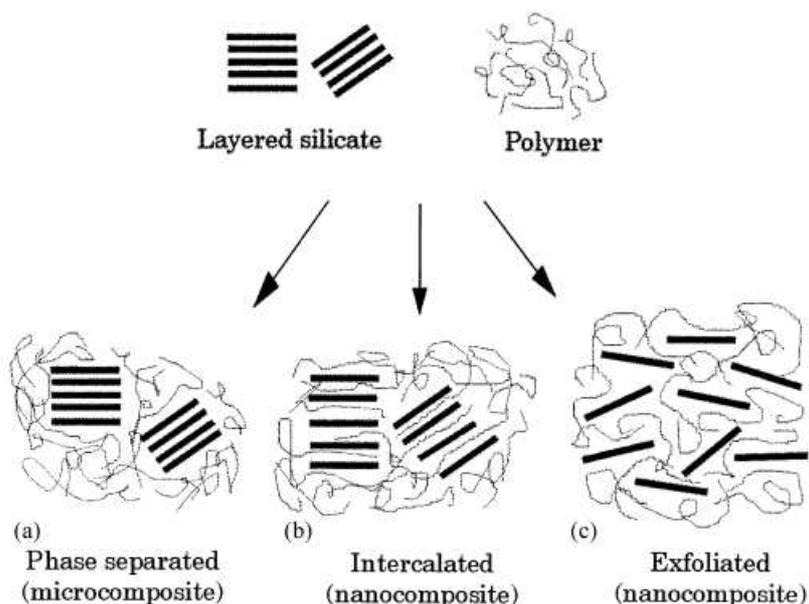
Figure 2.9: a) microcomposite, b) nanocomposite intercalé, c) nanocomposite exfolié <sup>[76]</sup>.
