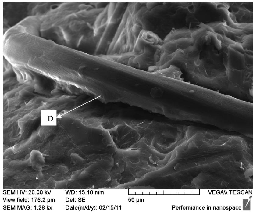
Figure 2.34: Image MEB d'un composite renforcé de fibres traitées par l'aminosilane (P30).
