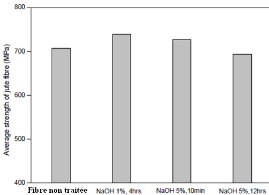
Figure 1.13 : Essai de traction sur des fibres de jute traitées avec différentes solutions de soude <sup>[15]</sup>.
