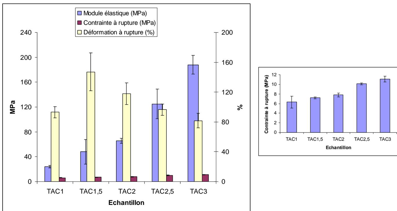
Figure 3.6 : Propriétés mécaniques des mélanges amidon/PVA en fonction de la teneur en agent de couplage.
