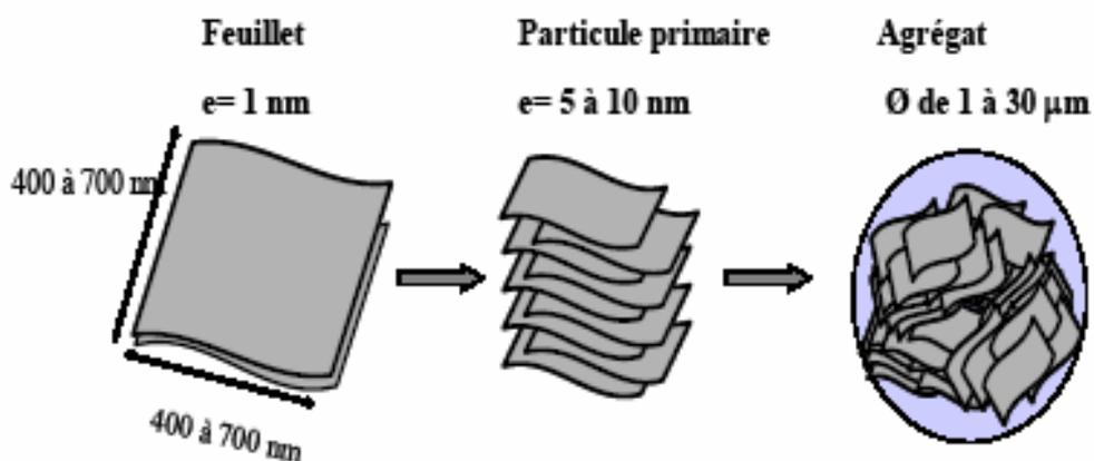
Figure 2.5 : Structure multi-échelle de la montmorillonite <sup>[27]</sup>.
