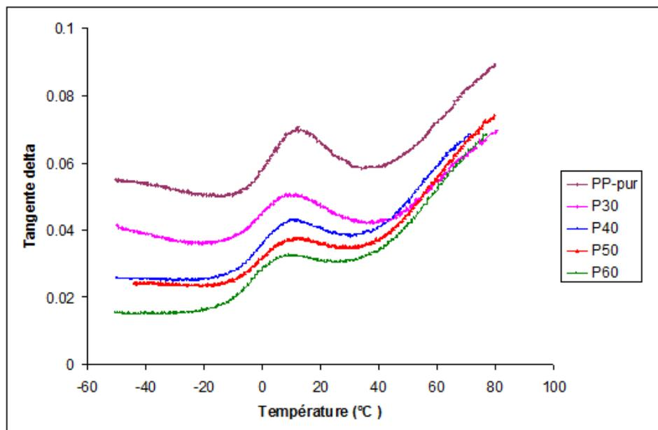
Figure 2.31 : Tangente delta ( $\text{Tan } \delta$ ) des composites à différents taux de fibres en fonction de la température.
