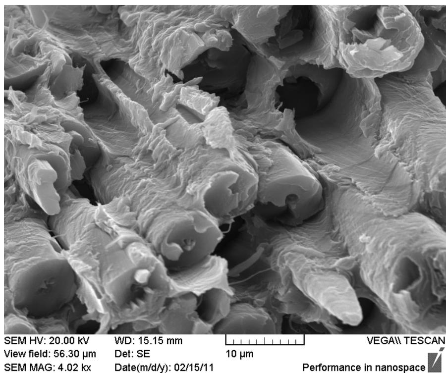
Figure 3.24 : Image MEB d'un composite amidon/PVA/fibre (TFB10).
