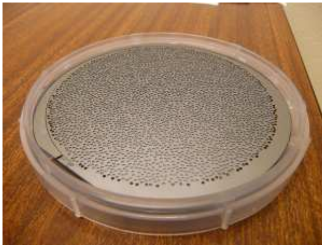
FIGURE IV.5 – Photographie de l'échantillon "D3" réalisé par les membres du LAAS, à Toulouse. Il s'agit d'un wafer de silicium de 4 pouces, épais de 406 \mu\text{m} et contenant une répartition aléatoire d'environ 3400 trous borgnes d'1 mm de diamètre et profond de 380 \mu\text{m} .
