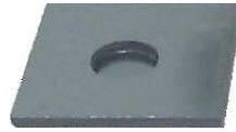
FIGURE III.25 – Photographie de l'échantillon après découpage d'un carré de 6 mm de côté autour du trou borgne.
