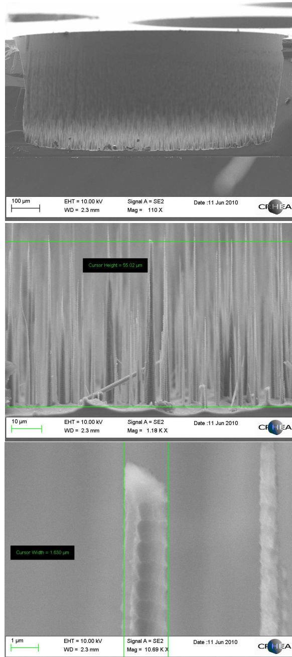
FIGURE E.6 – Images MEB de la tranche d'un wafer de silicium coupé au niveau d'un trou non traversant de 1 mm de diamètre. La largeur des images est, du haut vers le bas, de 1.5 mm, 150 µm et 15 µm.
