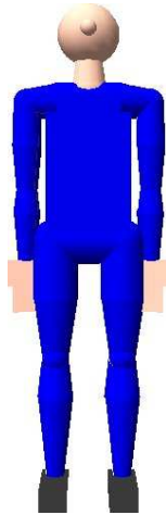
FIG. 2.20 – Mannequin complet composé de 19 corps et 37 articulations
