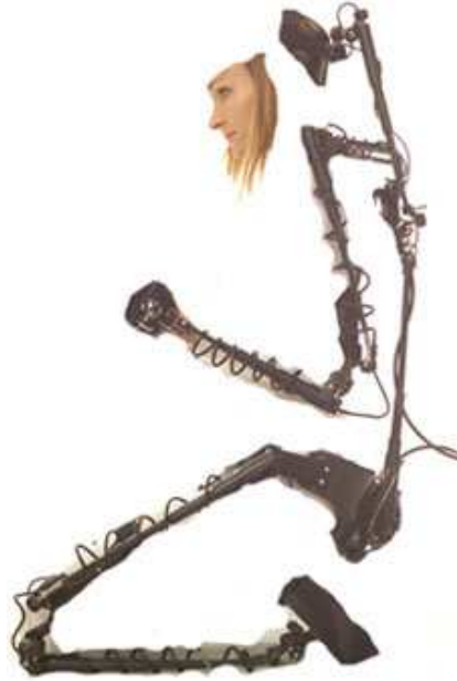
FIG. 1.5 – Capture mécanique grâce à un exosquelette de la gamme Gypsy de Animazoo
