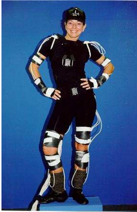
FIG. 1.6 – Système de capture magnétique Ascension Technology Motion Star
