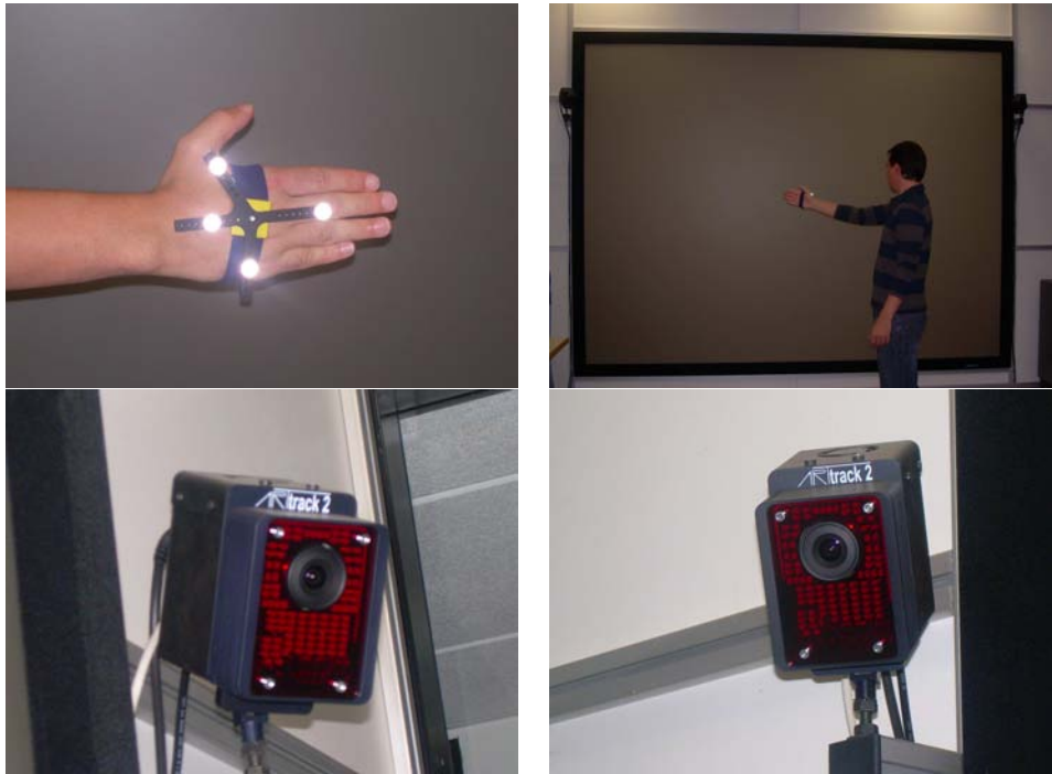
FIG. 3.4 – Marqueurs sphériques rétro-réfléchissants placés sur la main du sujet pour en récupérer la trajectoire et caméras infrarouges optiques ARTtrack2 utilisées pour la capture de mouvement
