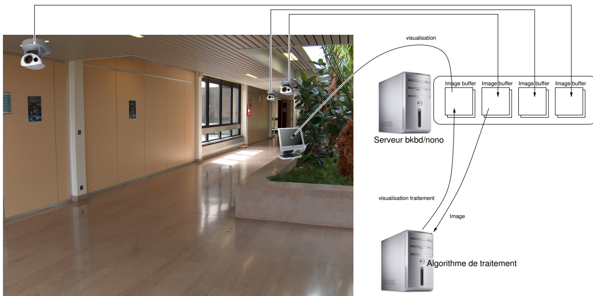
FIGURE 9.3 – La bibliothèque bkbd pour la plate-forme de vidéo-surveillance du campus de Metz de Supélec. Le serveur héberge 4 buffers d’image, munis d’un système de double-buffering. Le premier buffer (gauche) est lu par un client qui en visualise le contenu sur l’écran. Les trois autres sont connectés aux caméras, dont ils récupèrent l’image. L’exécution d’un traitement se fait sur une autre machine, qui dispose d’un client pour lire les images depuis un des buffers et poster le résultat du traitement sur le buffer qui est visualisé. Ainsi, le concepteur de l’algorithme ne se soucie ni de visualisation, ni du déploiement de la plate-forme.
