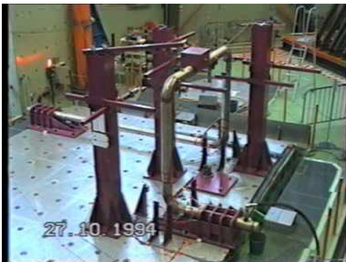
Figure 1: Vibration d'un tronçon de tuyauterie : Illustration de la vibration d'un tronçon de ligne de tuyauterie sur une table d'expérimentation du CEA (Laboratoire d'Études de Mécanique Sismique, EMSI). La structure est installée sur un plateau qui simule l'action sismique. La réponse de la structure à cette sollicitation présente une alternance entre les phases de déformation élastique et les phases de déformation plastique. Ici, la déformation permanente se manifeste aux coudées basses de la tuyauterie.
