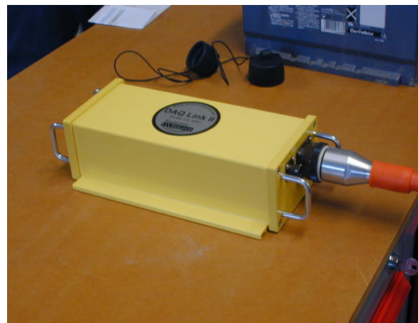
FIG. 11.6 – A gauche, générateur et amplificateur utilisés pour les expériences. A droite, l'enregistreur sismique DAQ LINK 24 voies.
