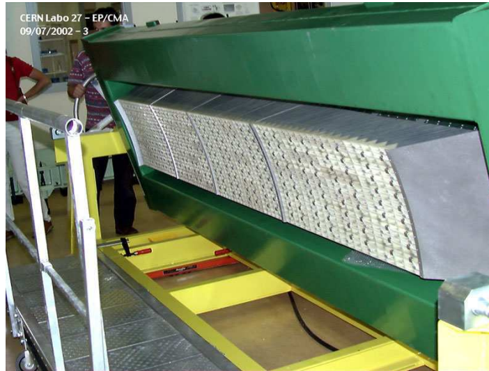
FIGURE 2.4 – Super-module du ECAL sur banc de test.
