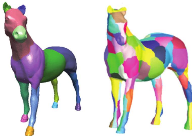
FIGURE 3.4 – Exemple de segmentation de maillage statique. A gauche, une segmentation sémantique. A droite, une segmentation géométrique [Shamir, 2008].
