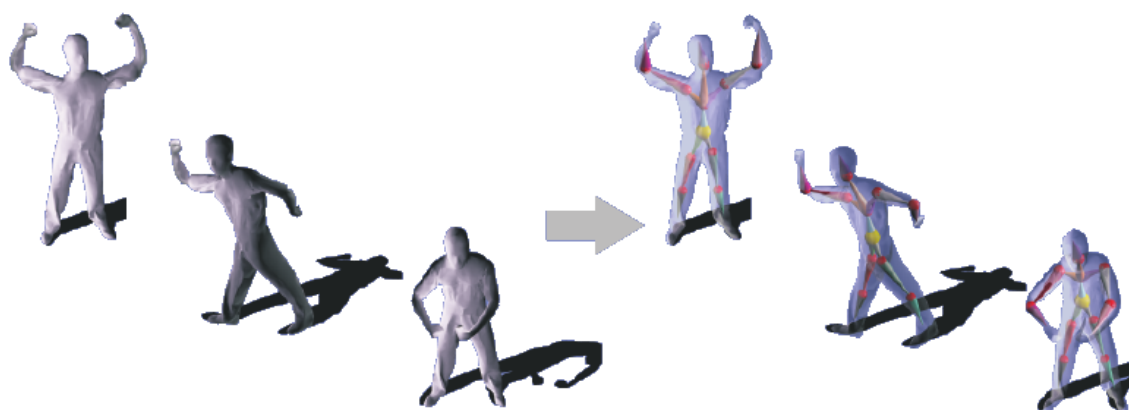
FIGURE 1.1 – Extraction de squelette [de Aguiar et al., 2008]. A partir d’une séquence de maillage existante (à gauche), un squelette d’animation ainsi que sa paramétrisation est calculé et l’animation peut être reconstruite (à droite).
