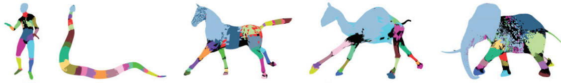
FIGURE 3.12 – Segmentations obtenues par [James and Twigg, 2005]. Les faces noires n'appartiennent à aucun cluster, de plus les clusters ne sont pas connexes.
