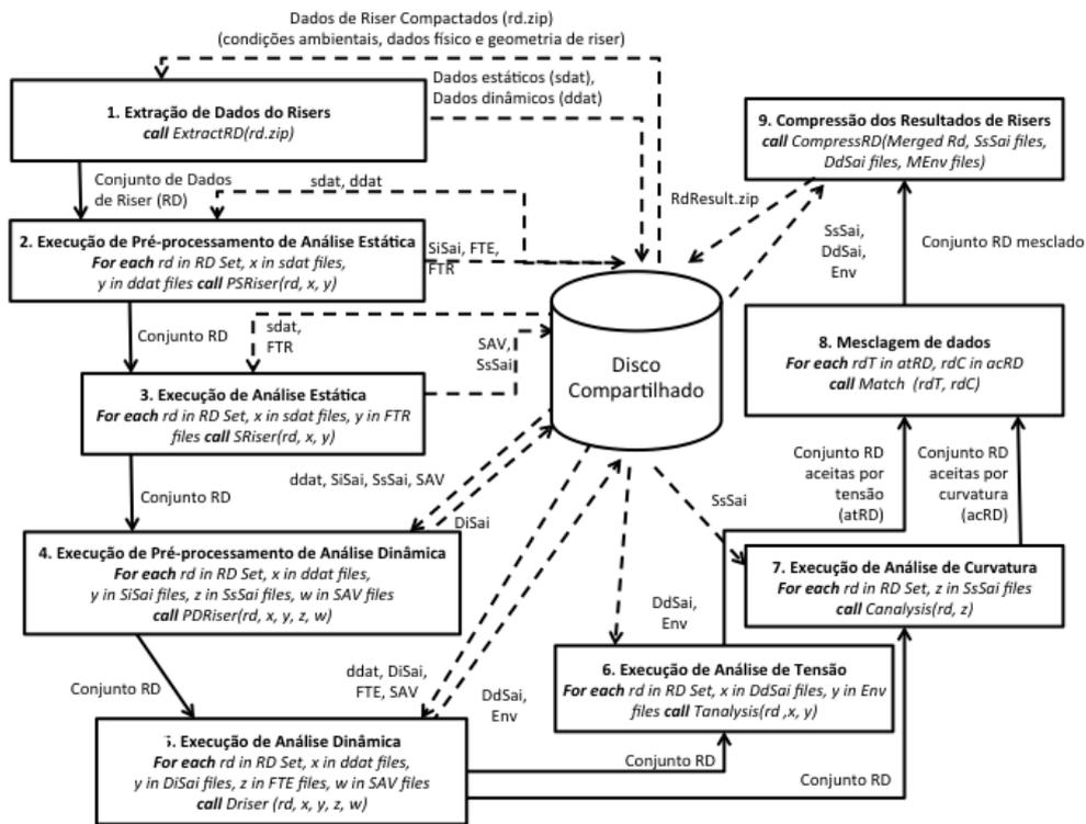
Figura 1 - *Workflow* para Análise de Fadiga de Risers (AFR).
