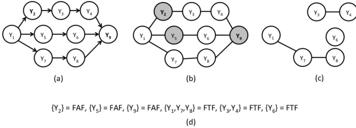
**Figura 21 - Workflow Científico (a); Identificação das atividades bloqueantes (b); Identificação dos componentes conexos a partir de conjuntos disjuntos (c); Fragmentos de workflows com atribuição de fluxo de dados definida (d)**
