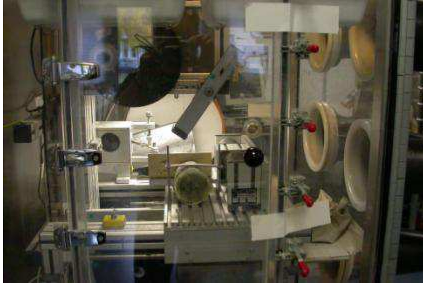
Figure 18 : Photo de la carotte 3715 (forage PH4) lors de sa découpe à la scie à fil en boîte à gants anoxique.
