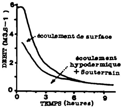
Fig. 114 : SEPARATION DE LA COMPOSANTE "ÉCOULEMENT DE SURFACE" (NAKAMURA 1971)
