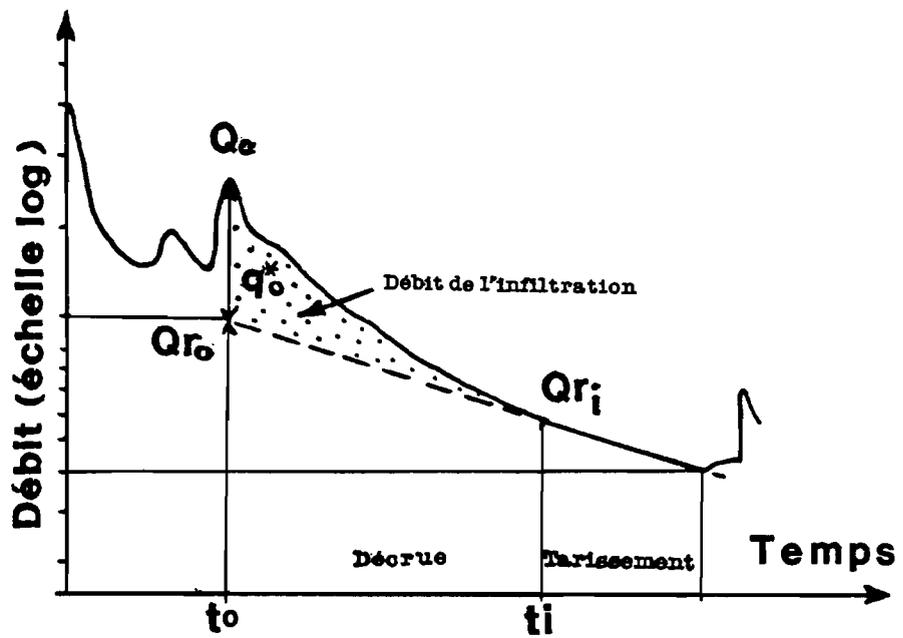
Fig. 143 : CONTRIBUTION DE L'INFILTRATION DETERMINEE PAR LA METHODE HYDRODYNAMIQUE .
