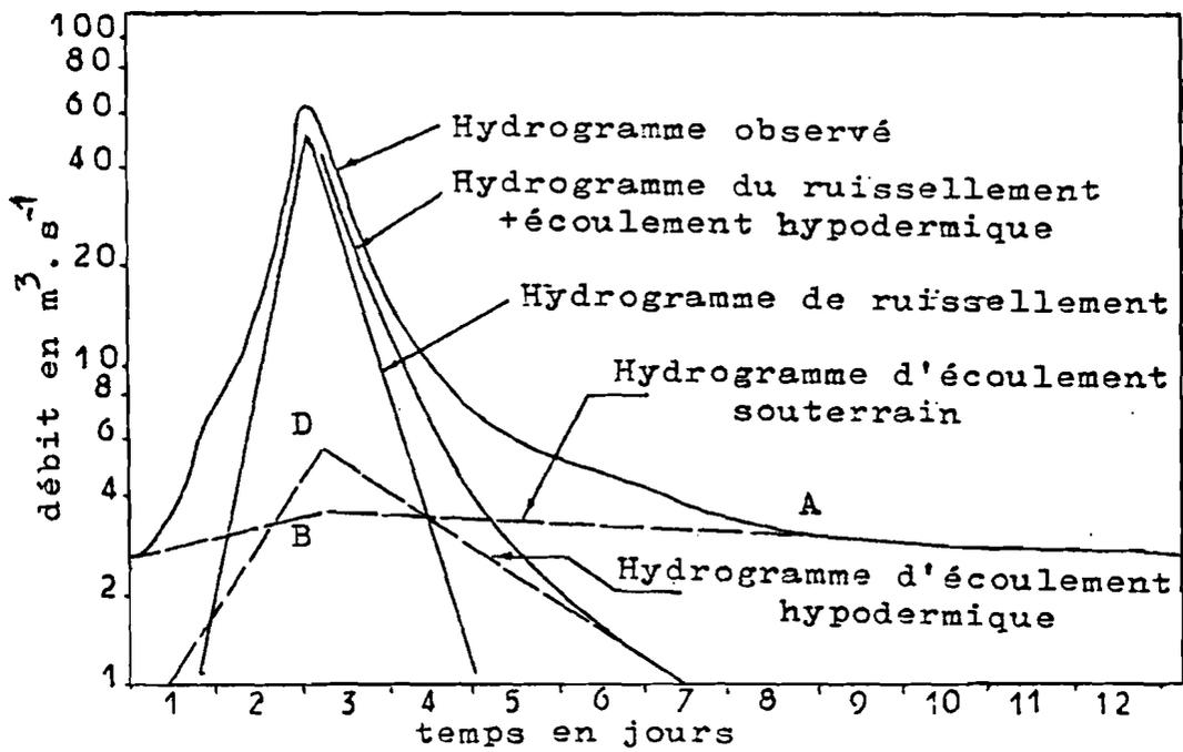
Fig. 109 : DECOMPOSITION HYDRODYNAMIQUE D'UN HYDROGRAMME DE CRUE (BARNES 1940)
